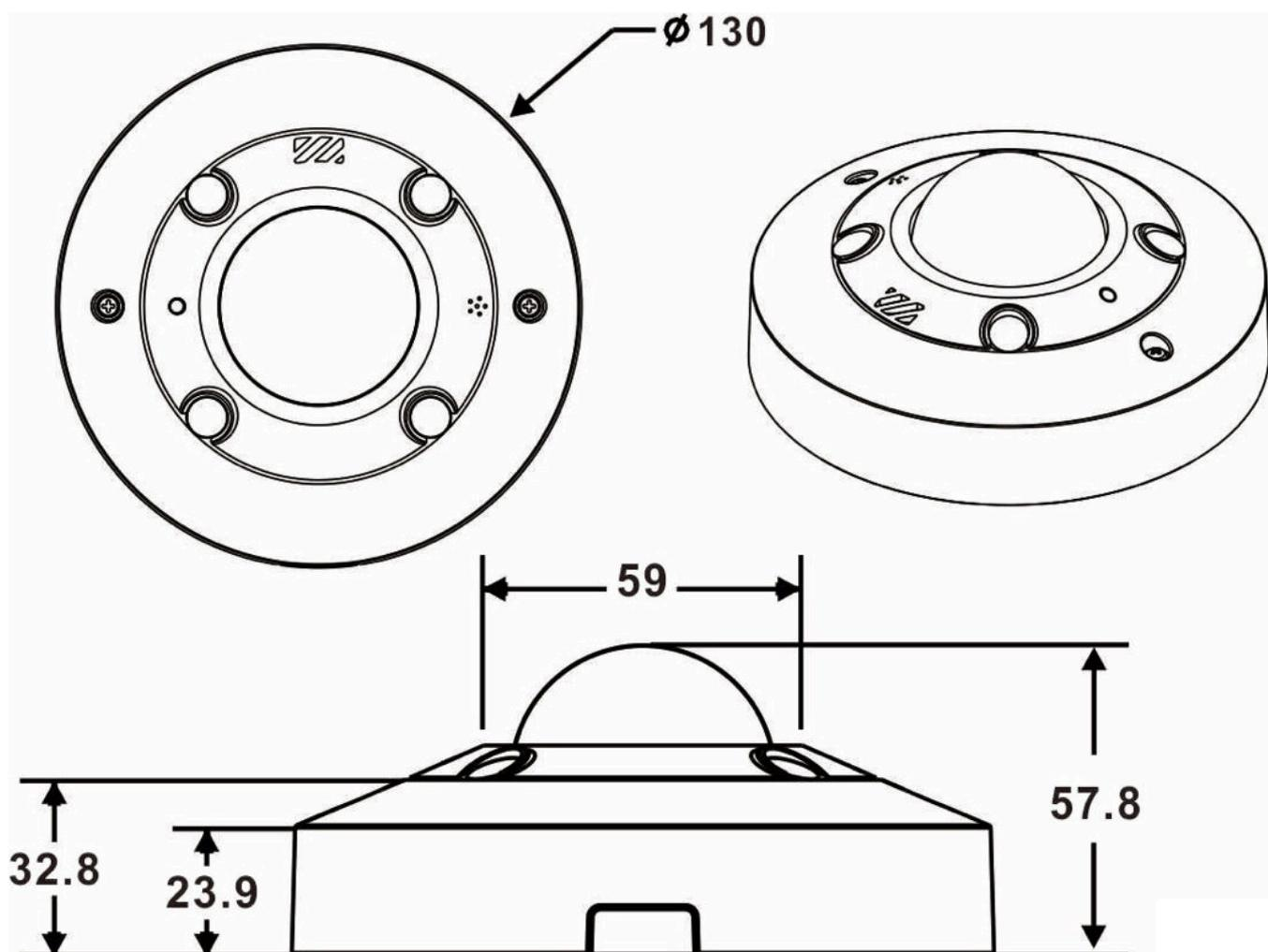
Fig. 1: Mx-VH1A-12-IR-VA: Todas las medidas en mm
