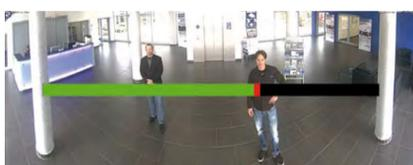
Drehen Sie das Objektiv mit der Hand vorsichtig hin und her, bis der rote Bereich der Scharfstellhilfe möglichst vollständig verschwunden ist.
