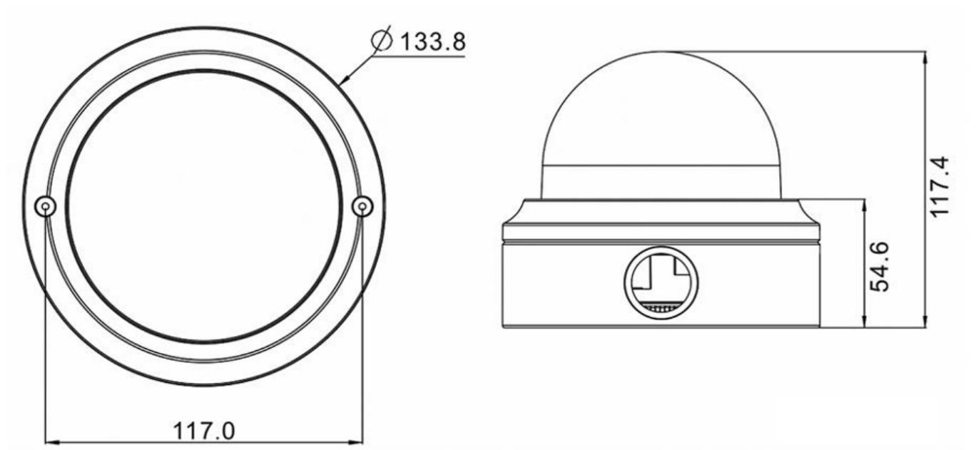
Fig. 1: Mx-VD3A-2-IR-VA: Todas las medidas en mm
