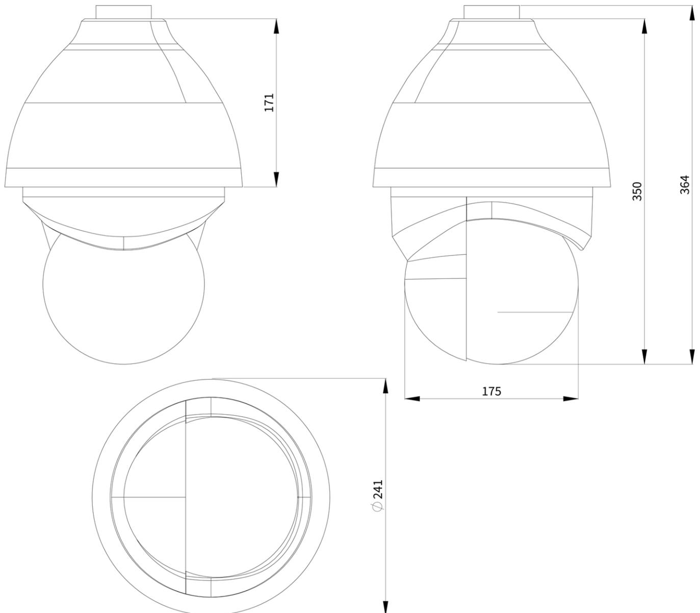
Fig. 1: Mx-SD1A-831-LIR-VA: Tutte le misure sono espresse in mm
