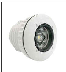
Mx-F-WLA-S M73/S74 Weißlichtstrahler für Standardobjektive 45-60° Weißlichtstrahler-Modul für MOBOTIX M73/S74 Kameras mit Bildwinkel 45-60° (horizontal) • IP66 • Reichweite in Verbindung mit dem Ultra LowLight Sensormodule: Standardobjektiv mit Strahler: bis zu 60 m
