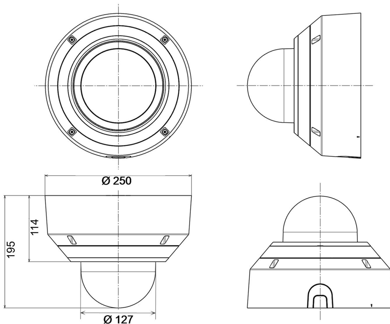
Fig. 1 : Mx-VMSD1A-2021-VA: Toutes les mesures sont en mm
