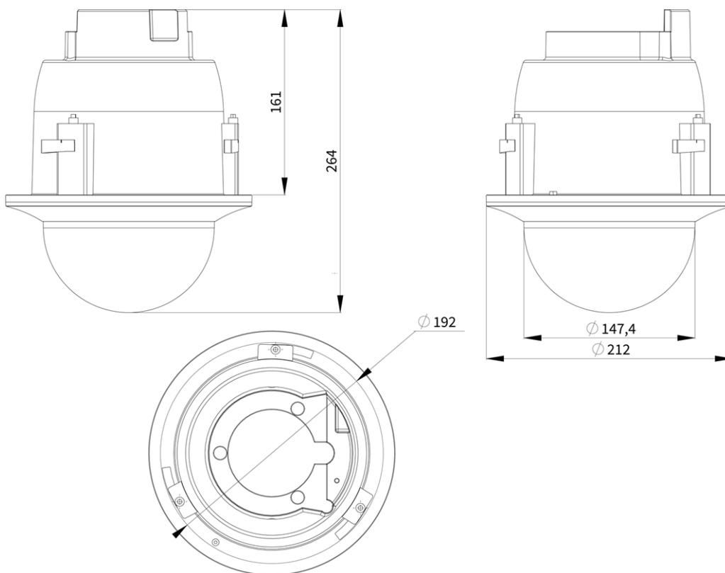
Fig. 1 : Mx-SD2A-230-LL-FM-VA: Toutes les mesures sont en mm
