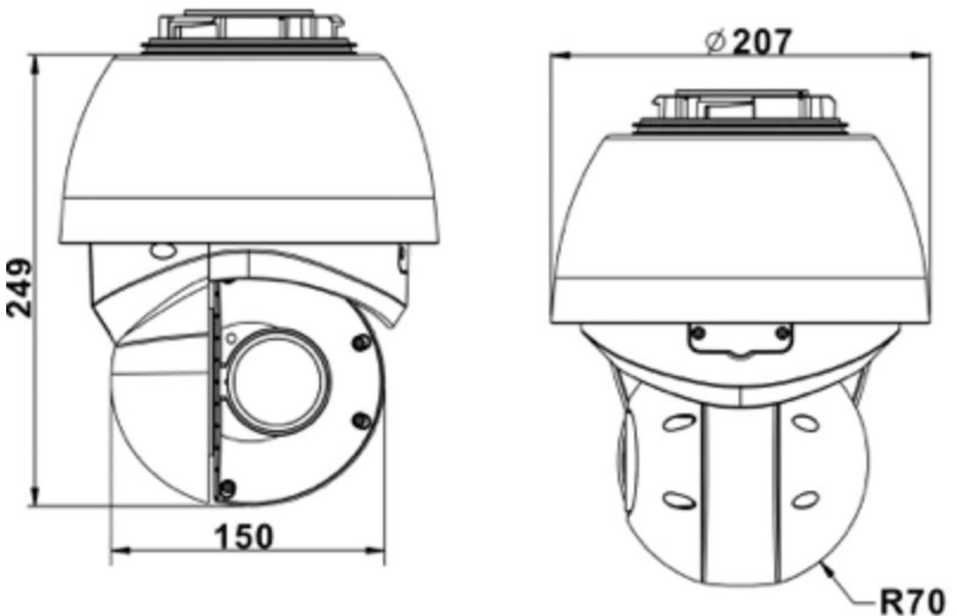
Fig. 1 : Mx-SD1A-540-IR-VA: Toutes les mesures sont en mm
