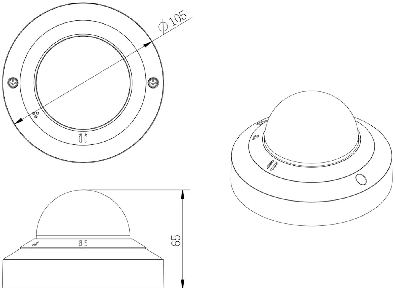
Fig. 1: Mx-MD1A-5-IR: Todas las medidas en mm
