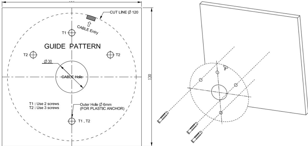
2. Taladre los tres orificios siguiendo la plantilla de perforación e inserte las clavijas de plástico suministradas.
