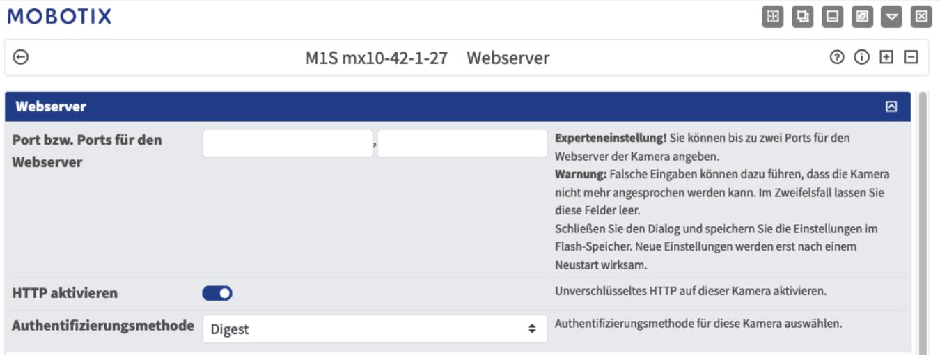
Diese HTTP-Authentifizierung ist eine anerkannte Methode, mit der sich der Nutzer eines Webbrowsers gegenüber dem Webserver (MOBOTIX Kamera) per Benutzername und Passwort authentifizieren kann. Bei der Digest Access Authentifizierung werden die Zugangsdaten nie im Klartext übermittelt und können so nicht „abgehört“ werden.
