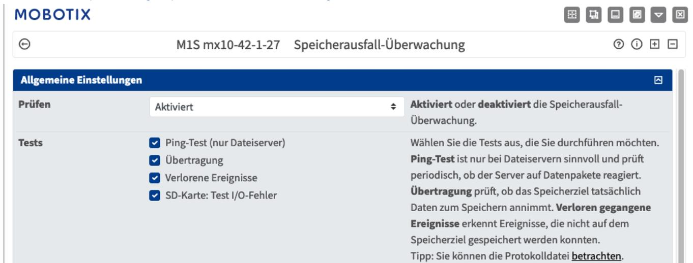
Im Dialog Speicherausfall-Überwachung richten Sie die Tests ein, die das von der Kamera als externer Ringspeicher verwendete Speicherziel (Dateiserver bzw. Flash-Medium) laufend kontrollieren. Die Kamera überprüft das verwendete Speicherziel aktiv und signalisiert plötzlich auftretende Probleme mit der Bildspeicherung über die hier festgelegten Meldewege.
