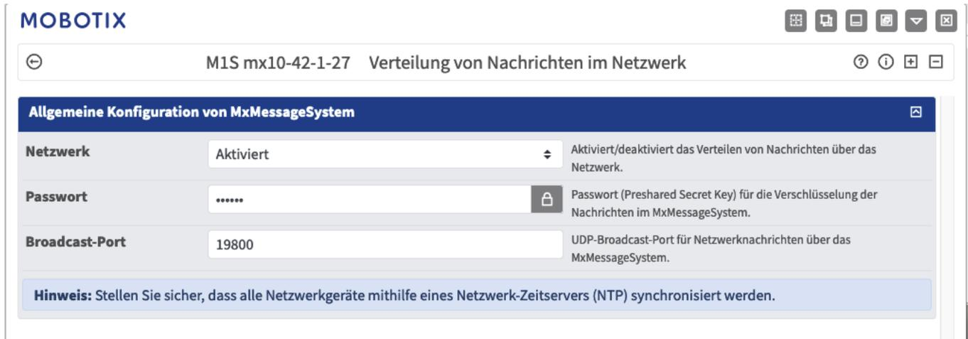
Das von MOBOTIX entwickelte MxMessageSystem dient dem Austausch von Nachrichten bzw. Steuerungsbefehlen zwischen den Kameras und Geräten im Netzwerk. Das zur Verschlüsselung dieser Nachrichtenübertragung gewählte Passwort (symmetrischer Schlüssel) sollte eine Mindestlänge von 6 Zeichen haben.
