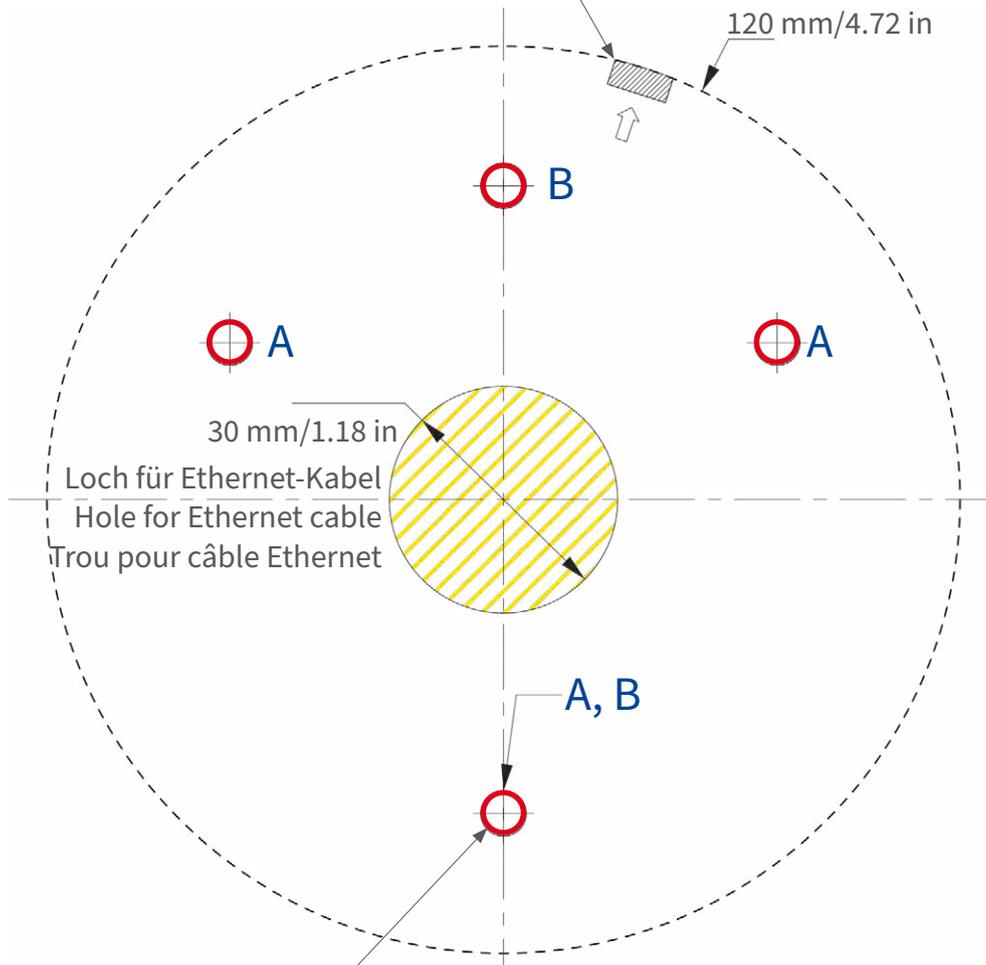
Bohrungen  $\varnothing$  6 mm für Dübel (3 x A oder 2 x B)
