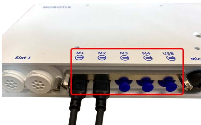
Fig. 22 : 4 ports de connecteur de module et 1 interface USB-C
