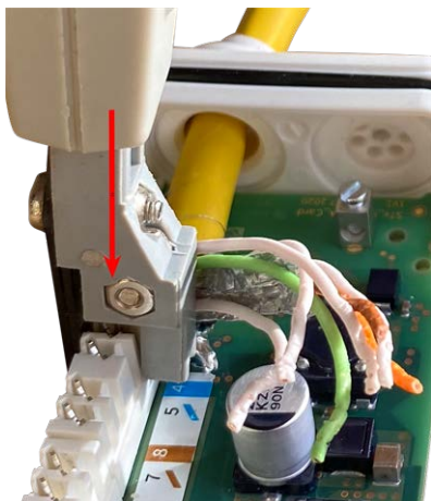
Fig. 13 : Fils réseau connectés à l'aide de l'outil LSA+/Krone
