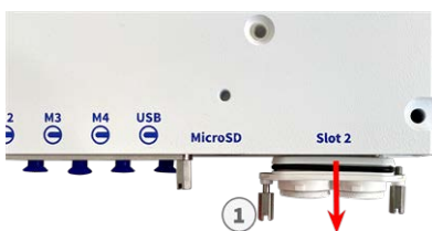
Fig. 9: Retire la cubierta de la ranura de la tarjeta de interfaz
