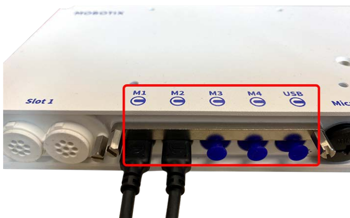
Fig. 22: 4 puertos de conexión de módulos y 1 interfaz USB-C
