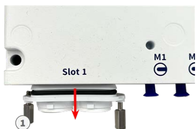
Fig. 18: Retire la cubierta de la ranura de la tarjeta de interfaz
