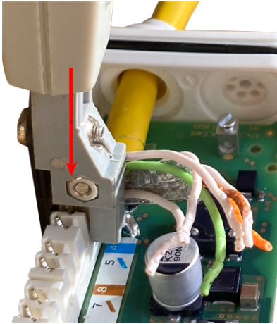
Abb. 13: Mit Krone LSA-Plus-Anlegewerkzeug angeschlossenes Netzkabel
