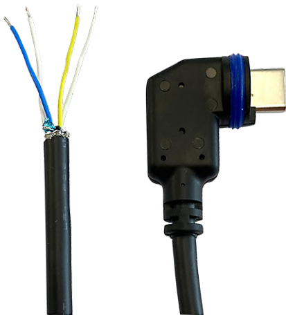
Abb. 21: Audiokabel mit zwei Aderpaaren
