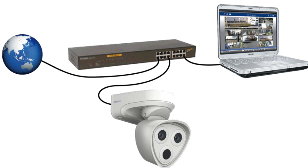
Fig. 18: Fuente de alimentación mediante un conmutador PoE según la PoE Plus (802.3at-2009)
