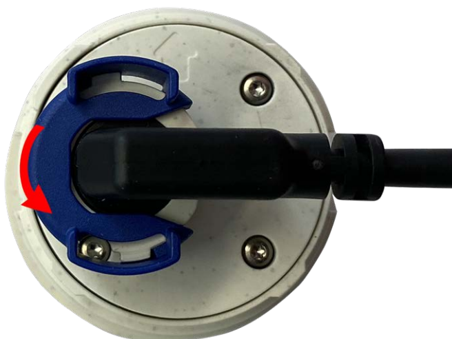
Fig. 7: Desbloqueo del cable del módulo de sensor
