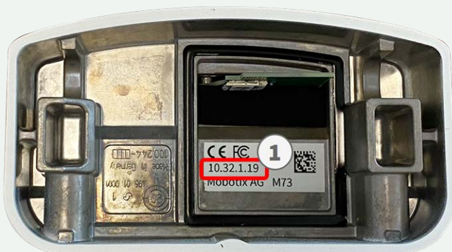
Fig. 5: Dirección IP en la parte posterior de la carcasa de la cámara
