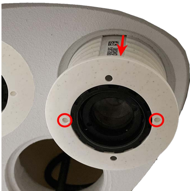
Fig. 10: Extracción del módulo de sensor desde la carcasa del módulo
