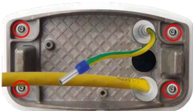
Fig. 21: Placa de montaje con cable de tierra y cable de red
