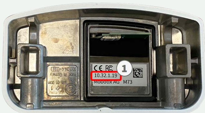
Fig. 2 : Adresse IP au dos du boîtier de la caméra
