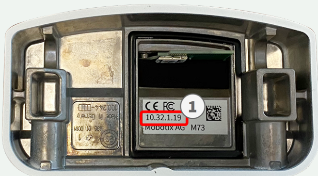
Abb. 2: IP-Adresse auf der Rückseite des Kameragehäuses
