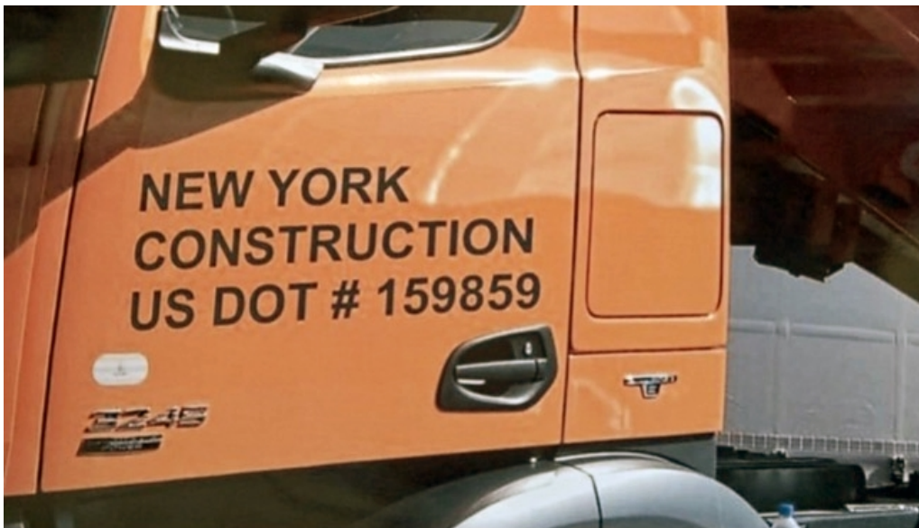
Fig. 9 : Exemple de code USDOT clairement reconnaissable
