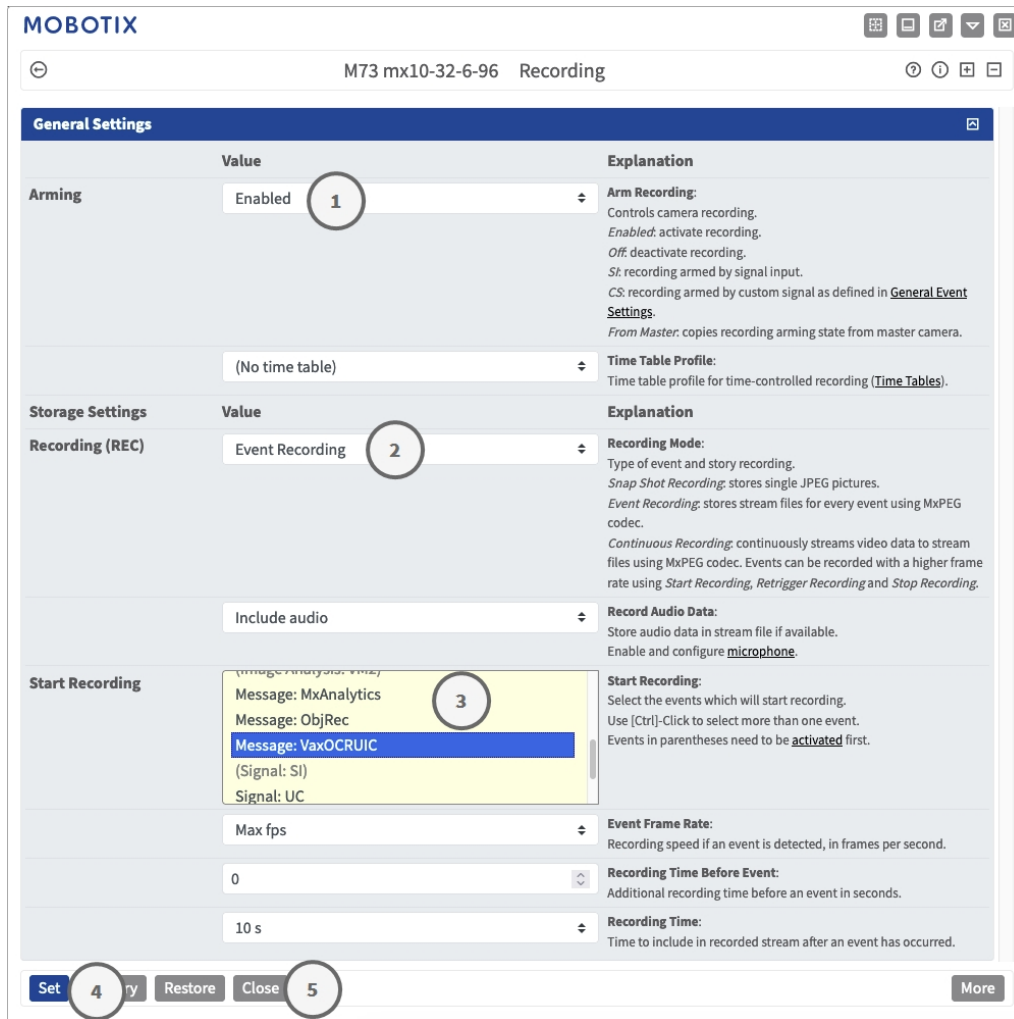
Abb. 22: Konfiguration der Aufnahmeeinstellungen der Kamera
