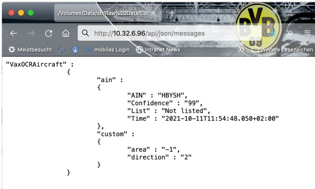
Abb. 15: Beispiel: Metadaten, die innerhalb einer MxMessage von Vaxtor Aircraft Identification Number Recognition App übertragen werden
