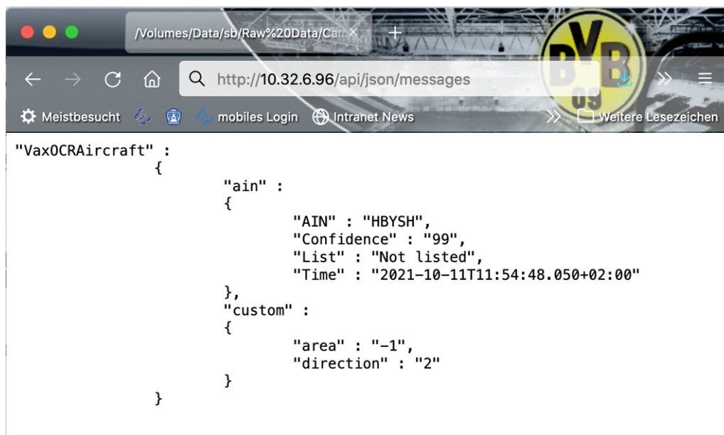
Fig. 16: Esempio: metadati trasmessi all'interno di un MxMessage di Vaxtor Aircraft Identification Number Recognition App
