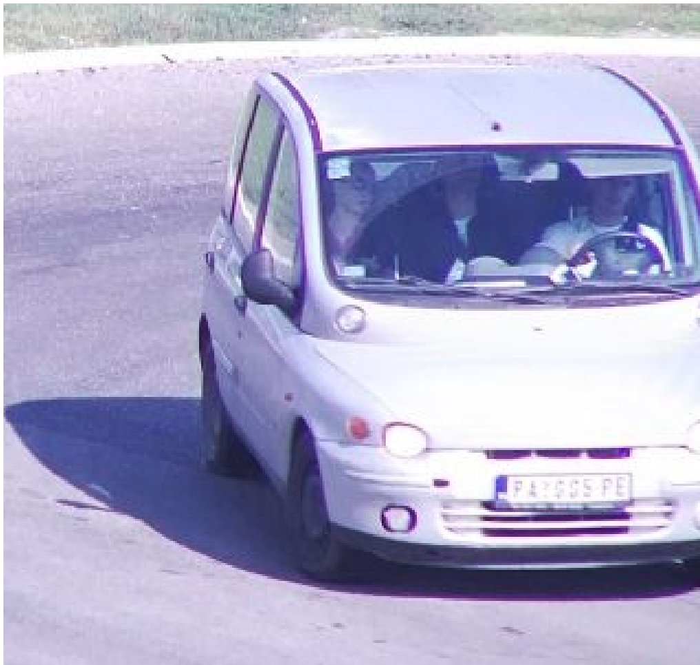
Abb. 15: Überbelichtetes Kennzeichen am Tag
