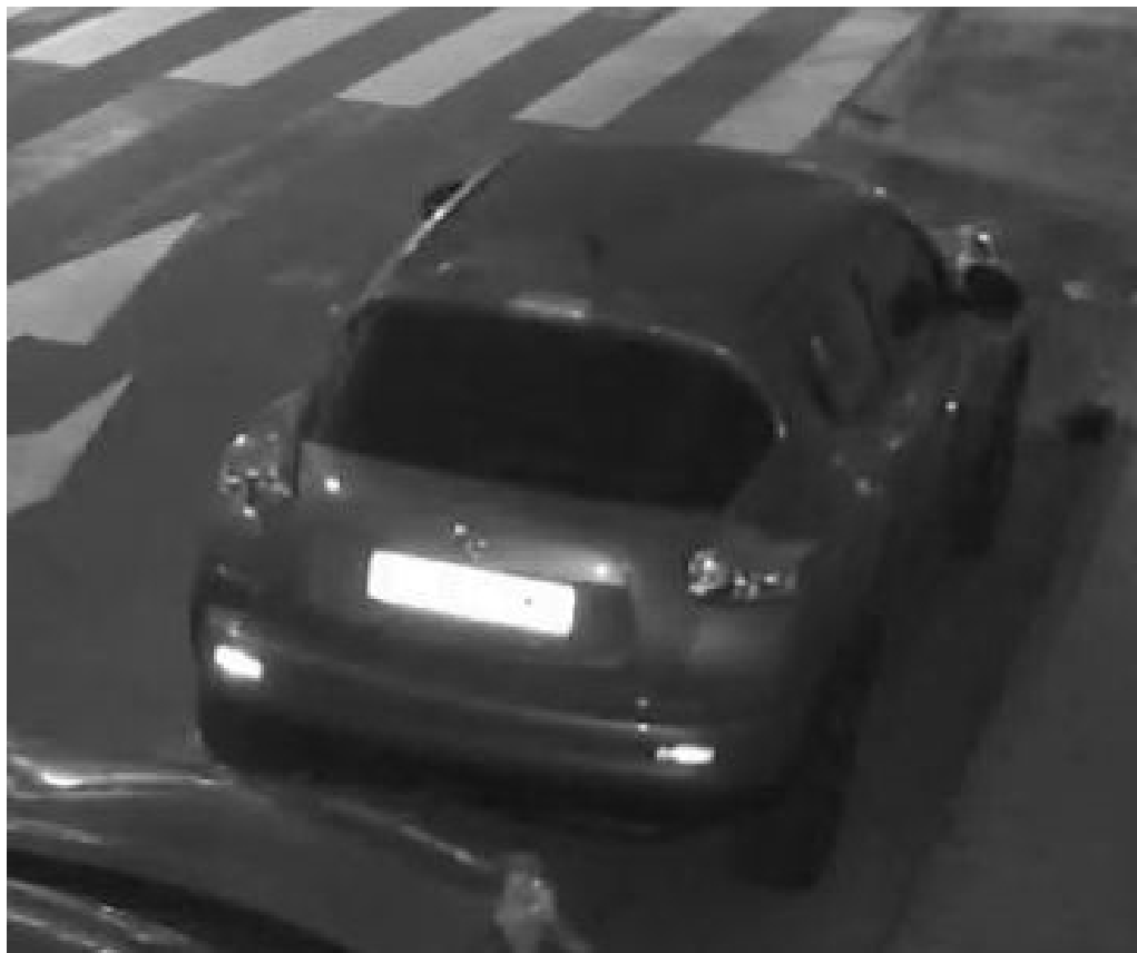
Fig. 16 : Plaques d'immatriculation surexposées à cause d'une lumière LED IR trop forte
