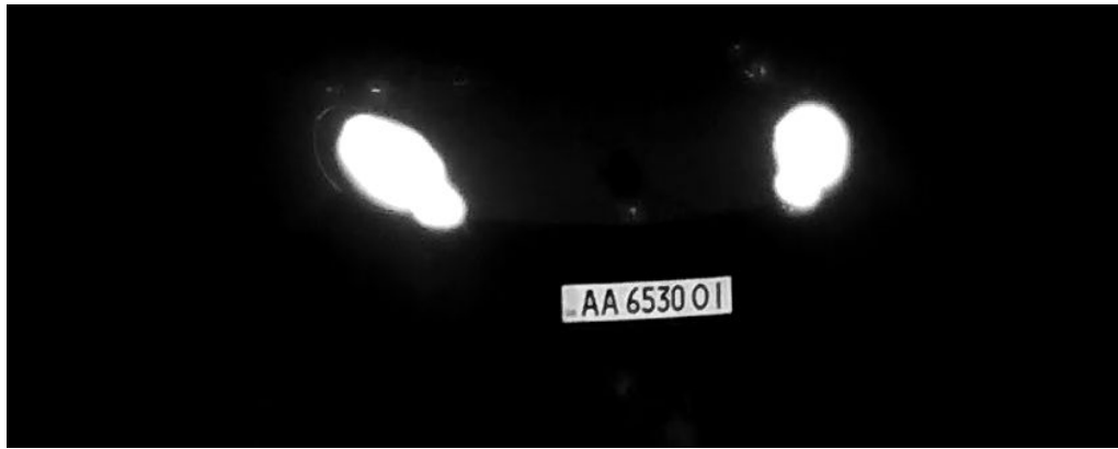
Fig. 10: Matrícula fácilmente legible por la noche con iluminación LED infrarroja
