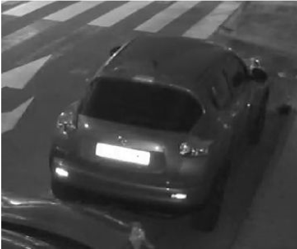
Fig. 16: Matrícula sobreexpuesta debido a luz LED IR demasiado intensa
