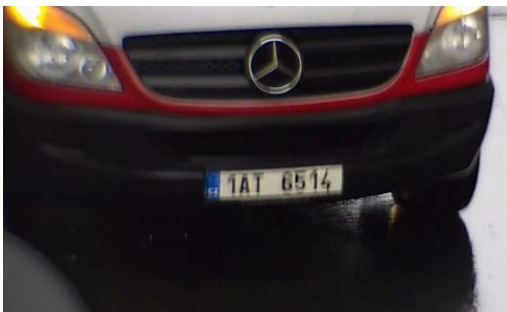
Fig. 14: Matrícula borrosa debido a un tiempo de exposición largo
