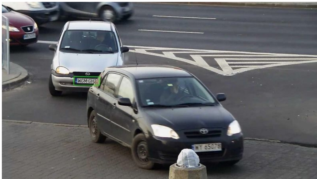
Fig. 13: Profundidad de campo insuficiente
