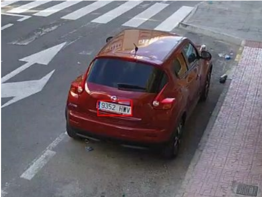
Abb. 18: Unzureichende Lichtverhältnisse zur Erkennung des Kennzeichens
