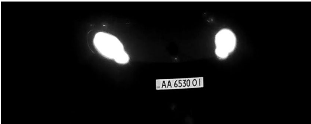
Fig. 10 : Plaque d'immatriculation facilement lisible de nuit avec un éclairage LED infrarouge
