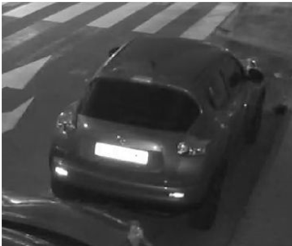
Fig. 16 : Plaques d'immatriculation surexposées à cause d'une lumière LED IR trop forte
