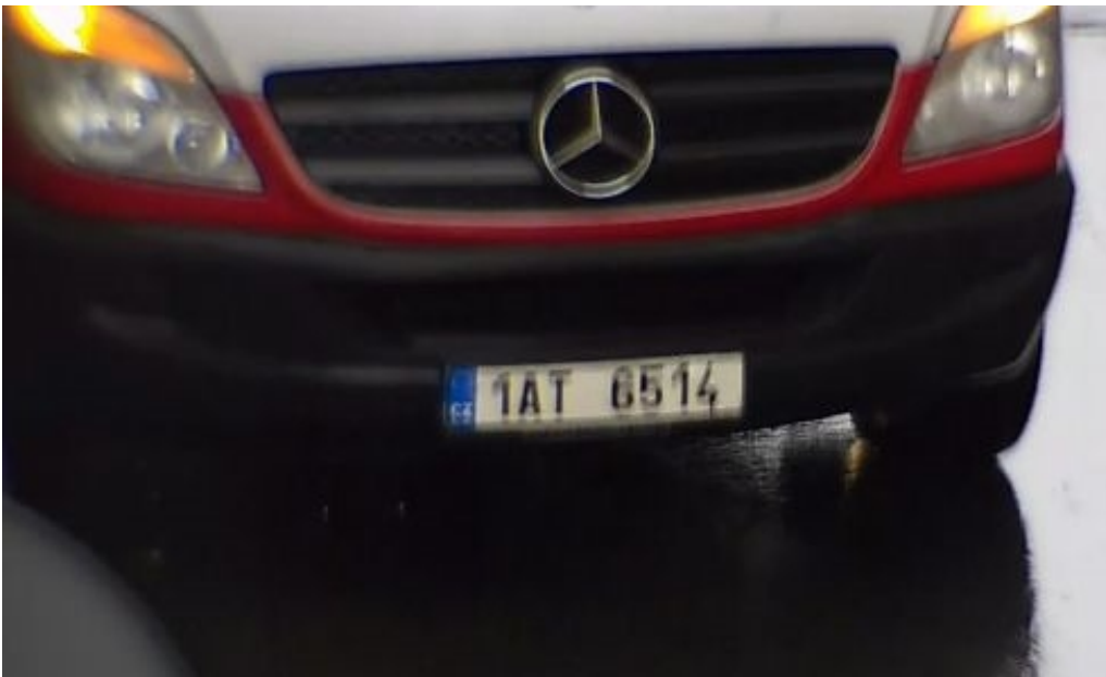
Abb. 14: Unscharfes Kennzeichen aufgrund langer Belichtungszeit
