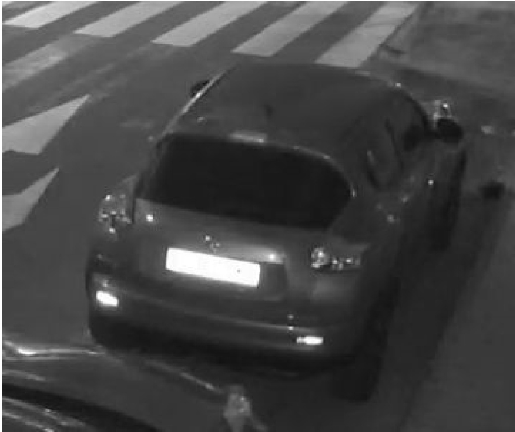
Abb. 16: Überbelichtete Kennzeichen aufgrund zu starken IR-LED-Lichts
