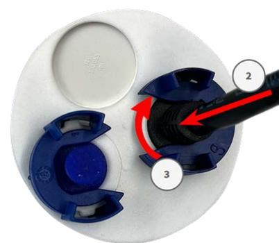
3. Fixez la fermeture à baïonnette ③ en la faisant pivoter dans le sens des aiguilles d'une montre.
