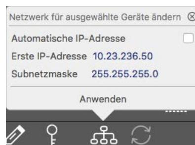
3. Entrez l'adresse IP et le masque de sous-réseau de la caméra sélectionnée.
