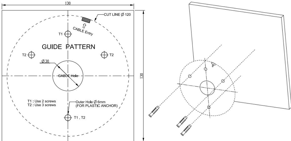
2. Bohren Sie die drei Löcher gemäß der Bohrschablone, und setzen Sie die mitgelieferten Kunststoffdübel ein.
