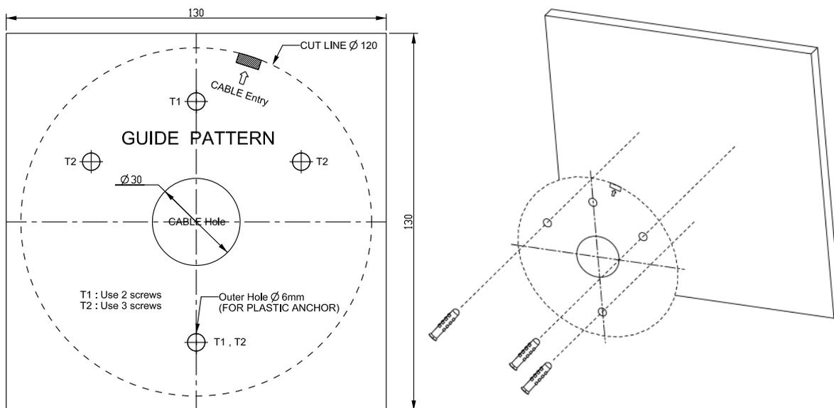
2. Taladre los tres orificios siguiendo la plantilla de perforación e inserte las clavijas de plástico suministradas.
