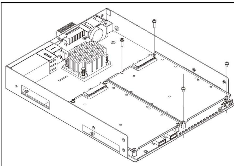
3. Fissare l'unità HDD con le viti di fissaggio fornite con l'unità HDD, come illustrato di seguito.
