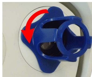
**ATTENTION !** Si les clips de sécurité rouges M.14 n'ont pas été mis en place, le module de capteur pivotera ! Dans ce cas, continuez de tourner jusqu'à ce que le module de capteur s'arrête dans sa position de dépose.
