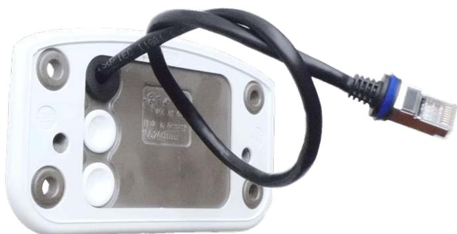
2. Le câble réseau fourni 1.4 est doté d'un joint en caoutchouc intégré. Poussez le câble réseau dans le trou supérieur de la plaque de montage, de sorte que l'entonnoir du bouchon en caoutchouc ① soit orienté vers la caméra.
