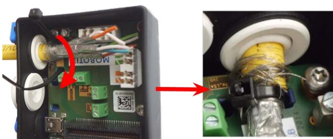
**Fig. 24 : Serre-câble inséré sous le câble réseau**
