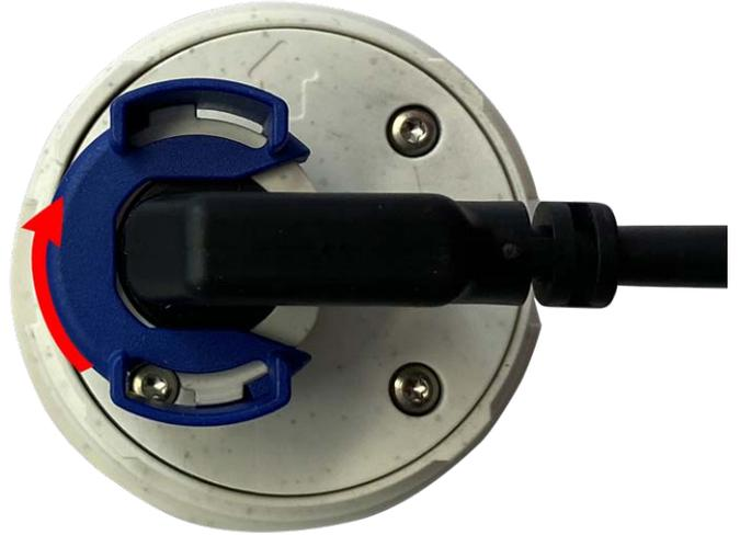
6. **Insérez un module de capteur :** Engagez le module de capteur dans sa prise. La flèche à l'arrière du module pointe vers 9 heures lorsque vous regardez le module comme illustré.
