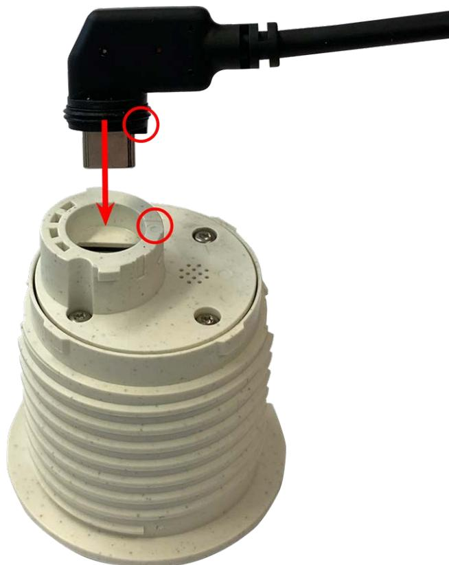
**ATTENTION !** La cosse de la fiche doit être orientée vers l'intérieur du module de capteur lorsqu'elle est branchée. Si le câble du module n'est pas branché correctement, le capteur ne sera pas reconnu par la caméra.
