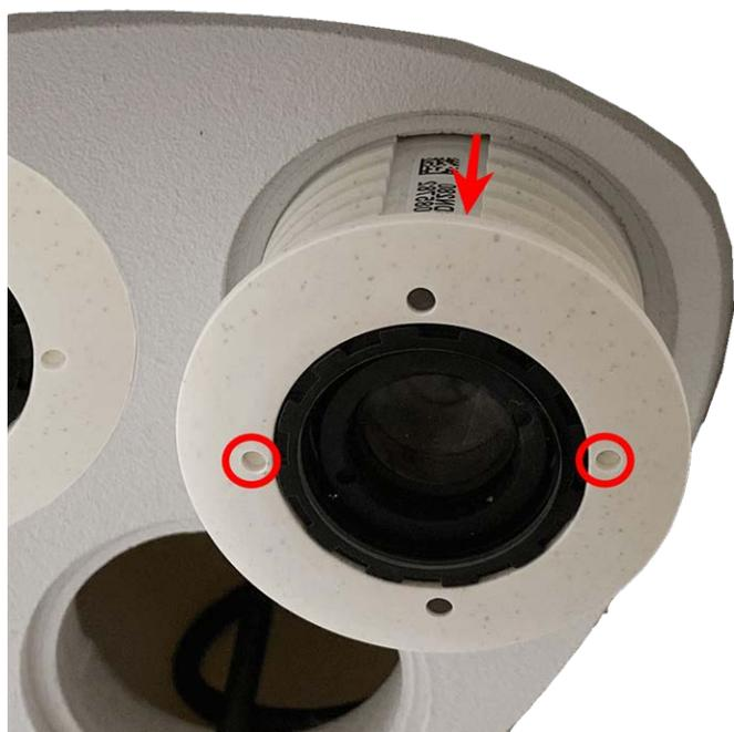
Fig. 10 : Retirez le module de capteur du boîtier du module
