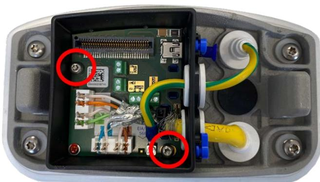
Fig. 30 : Montez le Connector Box LSA (vue de dessus) à l'aide des deux vis (surlignées en rouge sur la figure) sur la plaque de montage
