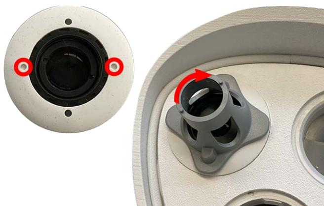
**ATTENTION !** Si vous ne parvenez pas à tourner le module de capteur, c'est qu'il a été inséré dans le mauvais sens ! Retirez le module de capteur, tournez-le de 180 degrés et réinsérez-le.
