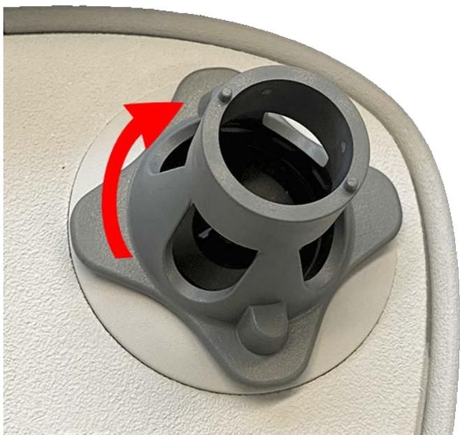
**ATTENTION !** Si vous ne parvenez pas à tourner le module de capteur, c'est qu'il a été inséré dans le mauvais sens ! Retirez le module de capteur, tournez-le de 180 degrés et réinsérez-le.
