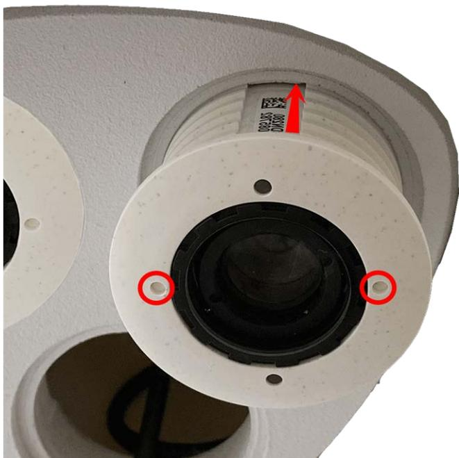
3. **Bloquez le module de capteur :** À l'aide de la clé de montage de module grise [M.1](#), tournez le module de capteur dans le sens des aiguilles d'une montre jusqu'à ce qu'il soit en butée.
