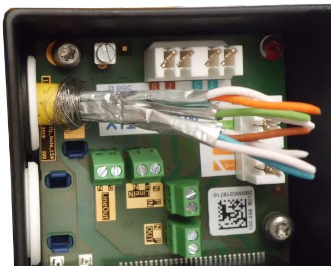
**Fig. 23 : Câble réseau inséré, bouchon correctement installé**
