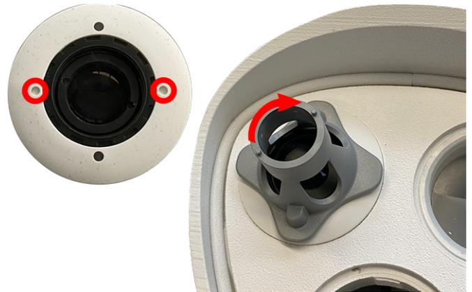
**VORSICHT!** Wenn Sie das Sensormodul nicht drehen können, wurde es falsch eingesetzt! Entfernen Sie das Sensormodul, drehen Sie es um 180 Grad und setzen Sie es erneut ein.
