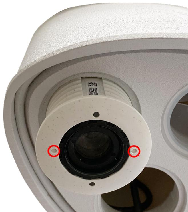
7. **Sensormodul verriegeln:** Drehen Sie das Sensormodul mit dem grauen Modulschlüssel [M.1](#) bis zum Anschlag im Uhrzeigersinn.
