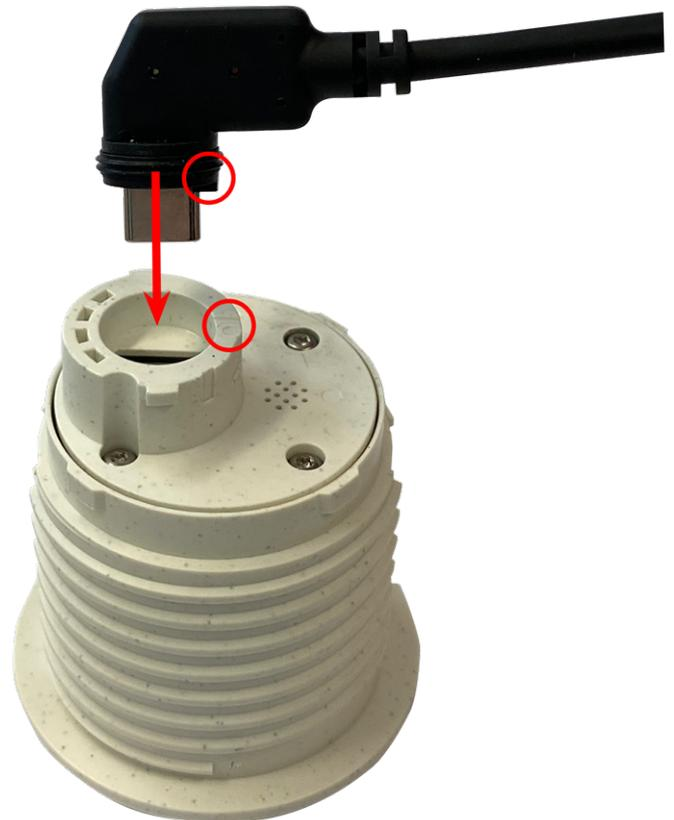
**VORSICHT!** Der Kabelschuh muss nach dem Anschließen zur Innenseite des Sensormoduls zeigen. Wenn das Modulkabel nicht richtig eingesteckt ist, erkennt die Kamera den Sensor nicht.
