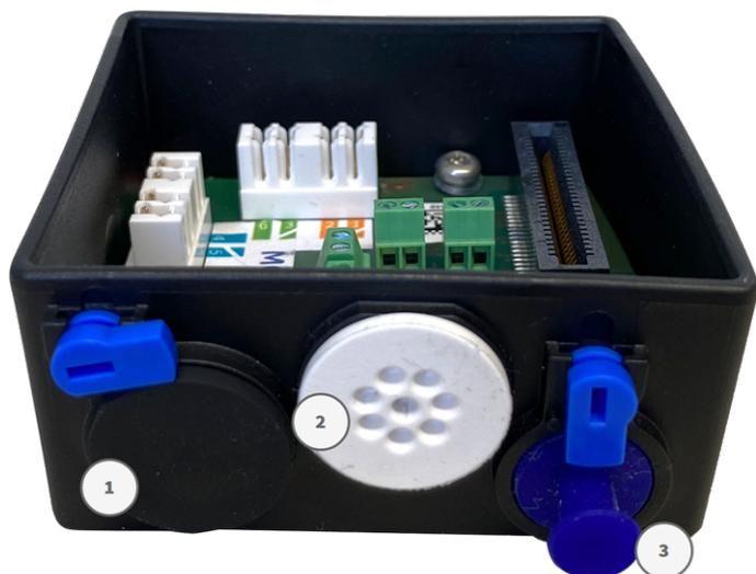
Abb. 19: Connector Box LSA mit Gummistopfen, schwarz C.3 ① ; Gummistopfen, einadrig C.4 ② ; USB-Stecker ③ und zwei blauen Verriegelungen
