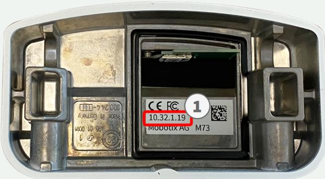
Abb. 5: IP-Adresse auf der Rückseite des Kameragehäuses
