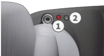
**HINWEIS!** Wenn Sie die Taste der Kamera drücken, wird die aktuelle IP-Adresse der Kamera über den Lautsprecher ausgegeben (wenn ein Lautsprecher an der Kamera angeschlossen ist).
