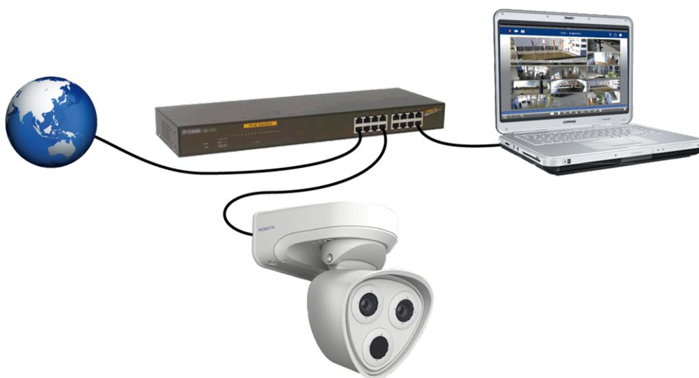
Abb. 18: Stromversorgung über PoE-Switch gemäß PoE Plus (802.3at-2009).
