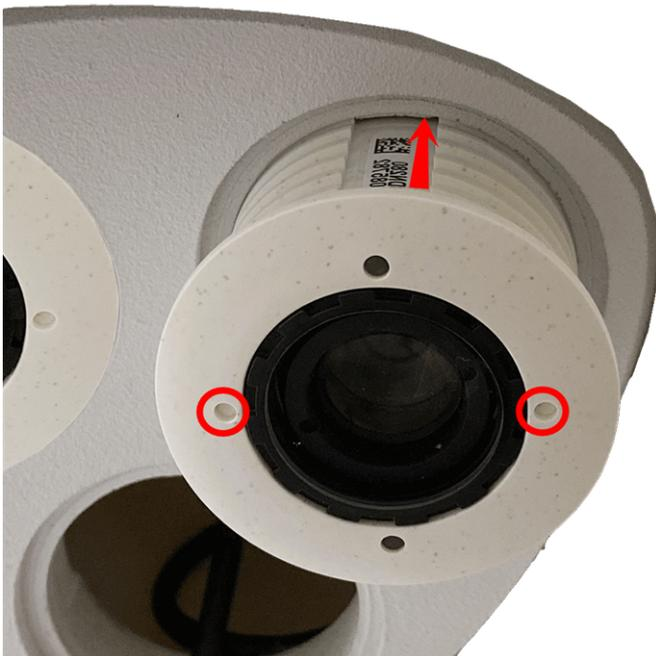
3. **Sensormodul verriegeln:** Drehen Sie das Sensormodul mit dem grauen Modulschlüssel [M.1](#) bis zum Anschlag im Uhrzeigersinn.
