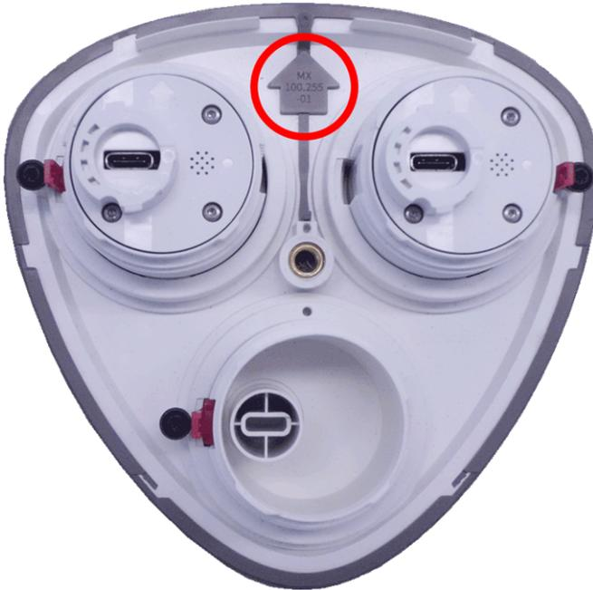
2. Schieben Sie die Frontplatte bis zum Anschlag in das Modulgehäuse.
