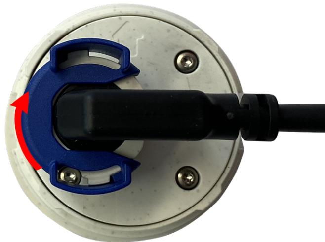
6. **Sensormodul einsetzen:** Schieben Sie das Sensormodul in seine Aufnahme. Der Pfeil auf der Rückseite des Moduls zeigt auf 9 Uhr, wenn Sie das Modul wie dargestellt betrachten.
