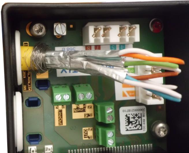
Abb. 23: Netzkabel eingesteckt, Stopfen richtig eingesetzt
