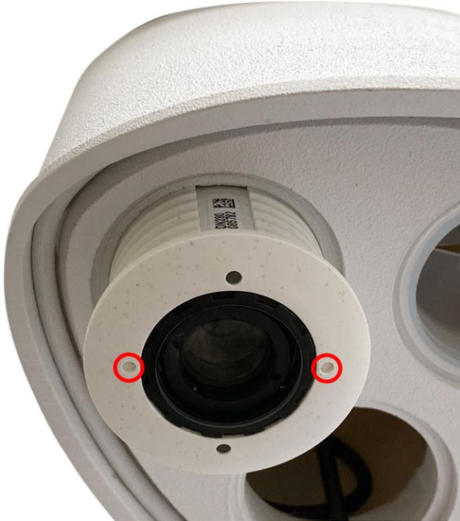
Abb. 9: Sensormodul entriegeln
