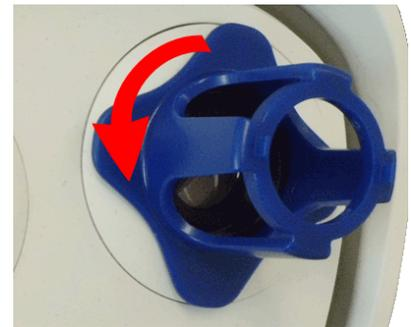
**VORSICHT!** Wenn die roten Sicherheitsclips M.14 nicht angebracht wurden, dreht sich auch das Sensormodul! Drehen Sie in diesem Fall weiter, bis das Sensormodul in seiner Ausbauposition anhält.
