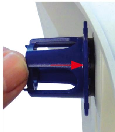
9. Drehen Sie das Schutzglas mit dem blauen Linsenschlüssel im Uhrzeigersinn, bis es einrastet.
