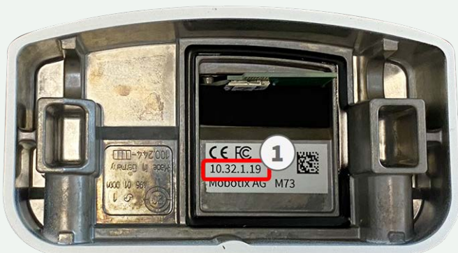
Fig. 2: Dirección IP en la parte posterior de la carcasa de la cámara
