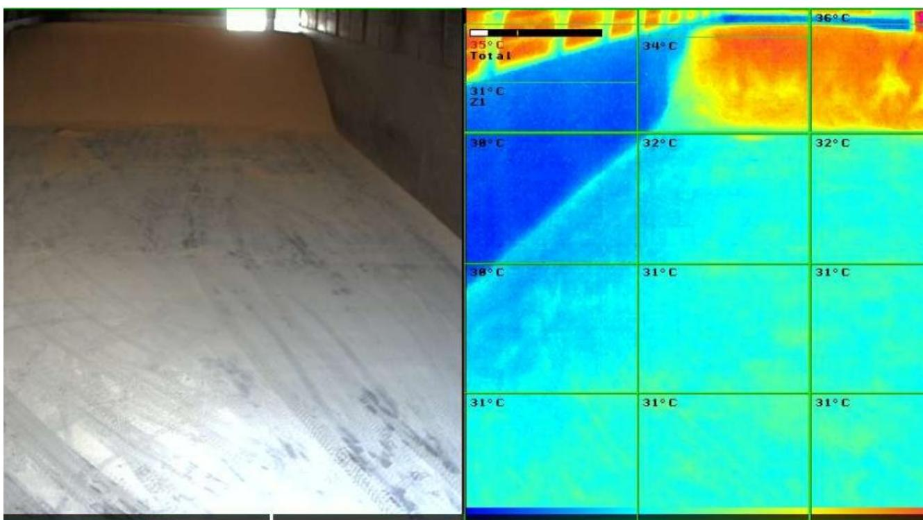
El sistema de vídeo inteligente M16 Thermal con un sensor térmico de gran potencia integrado y con función "Thermal Overlay" (superposición térmica) permite identificar claramente en la imagen puntos calientes
